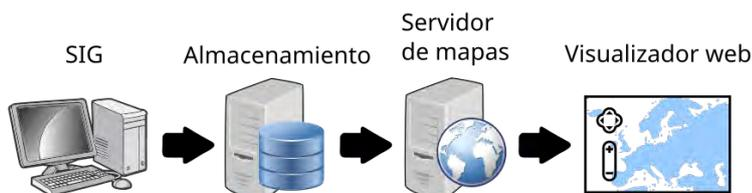
Figura 1.5: Una forma simple de esquematizar una IDE. Imágenes de FreeSVG.
