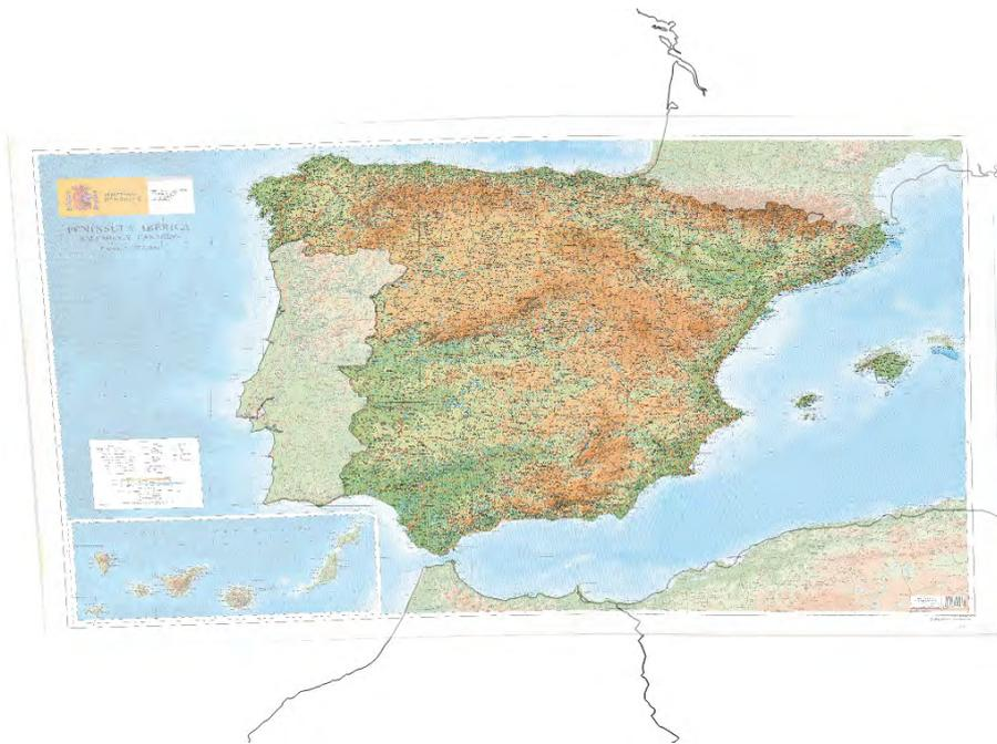
Figura 3.38: El algoritmo recorta del ráster el contorno del país como si fuera una tijera. En la imagen se observa la capa recortada con mayor contraste.
