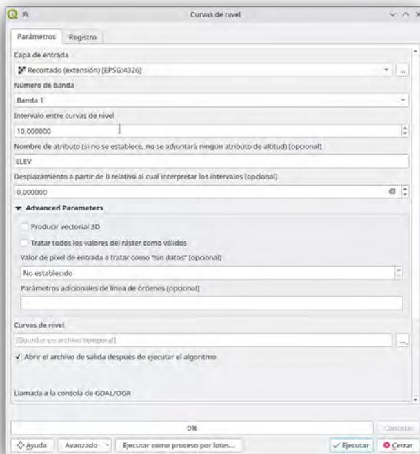
Figura 3.44: Las curvas se calculan sobre el archivo ráster recortado. Se ha configurado que la distancia entre líneas sea de 10 metros (por defecto).
