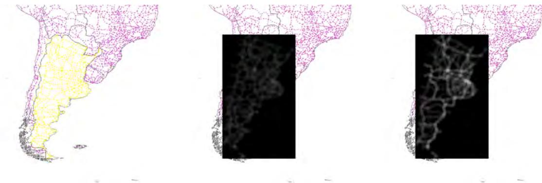
Figura 5.99: La primer imagen muestra la selección de las rutas Argentinas. En la segunda imagen se ha calculado la densidad lineal en un radio de 50km. La tercera imagen se ha recalculado con igual radio pero ponderando la importancia de cada ruta (invirtiendo previamente la escala de los valores de «scalerank»).
