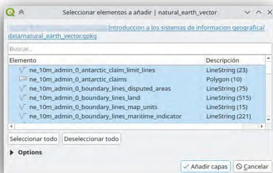
Figura 2.6: Cuadro de diálogo del *GeoPackage*. Como se observa el archivo contiene muchas capas vectoriales de distinta geometría: *Point* (puntos), *LineString* (líneas) y *Polygon* (Polígonos).
