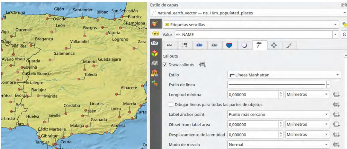
Figura 6.48: Se observan las líneas de tipo *Manhattan* (rectas verticales y horizontales en forma de L) que unen cada punto con su etiqueta.
