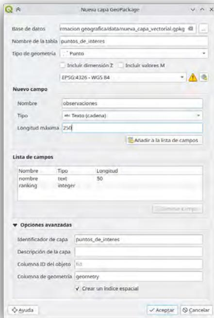
Figura 3.28: Nueva capa *GeoPackage* de puntos: «puntos\_de\_interes». A modo de ejemplo, se configuraron algunos campos.
