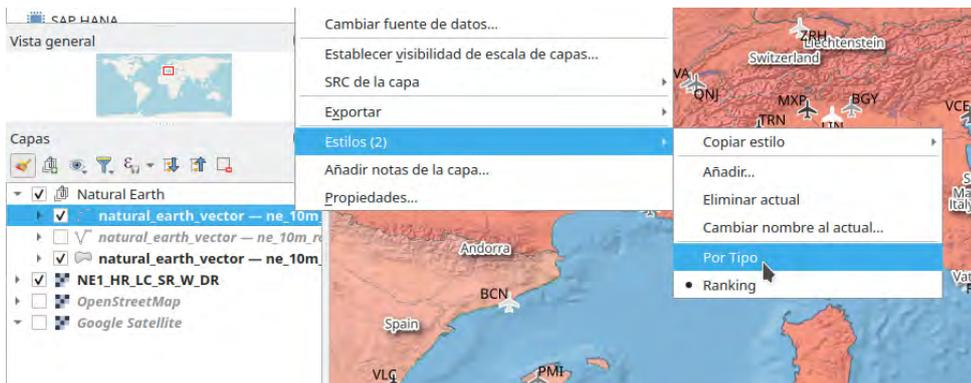
Figura 2.46: Selección de estilos. QGIS indica entre paréntesis cuántos estilos hay guardados en el proyecto para esa capa.
